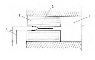
Рисунок 1. Датчик задержки внутренней забойки в шпуре. Figure 1. The sensor of the internal tamping retention in the borehole.
