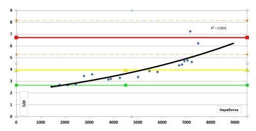
Рисунок 2. Обобщение результатов расчета ЕДК для расцентровки валов энерго-механического оборудования карьерных экскаваторов и построение среднесрочного прогноза в зависимости от наработки Figure 2. Generalization of the results of the calculation of the EDC for the alignment of shafts of power-mechanical equipment of quarry excavators and the construction of a medium-term forecast depending on the operating time
