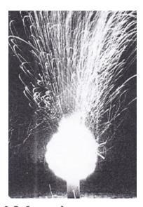
Рисунок 2. Выброс продуктов взрыва из шпура при взрывании без внутренней забойки Figure 2. Ejection of explosion products from the borehole during blasting without internal tamping
