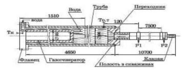
Рисунок 4. Схема размещения оборудования, клапанов и датчиков давления и температуры при стендовых испытаниях УГГИ-93 с имитацией скважины. P — датчик давления; T — датчик температуры Figure 4. Layout of equipment, valves and pressure and temperature sensors during bench tests of UGGI-93 with borehole simulation. P — pressure sensor; T - temperature sensor
