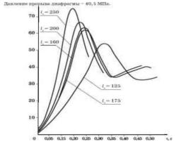
Рисунок 3. Зависимости давления P в камере УДВ от времени  $\tau$ :  $I_{_3}$  — длина шашки, мм.
