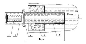
Рисунок 2. Расчетная схема математической модели гидроимпульсной установки: 1 — заряд баллиститного топлива; 2 — камера сгорания; 3 — диафрагма; 4 — ствол; 5 — рабочая жидкость Figure 2. Calculation scheme of the hydropulse installation mathematical model: 1 — charge of ballistite fuel; 2 - combustion chamber; 3 - diaphragm; 4 - trunk; 5 - working fluid
