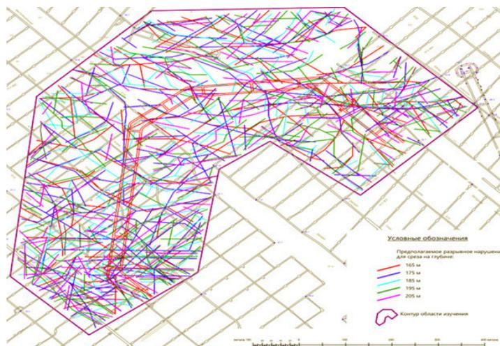
Рисунок 3. Разрывные нарушения участка уклонного блока 1Т-4
