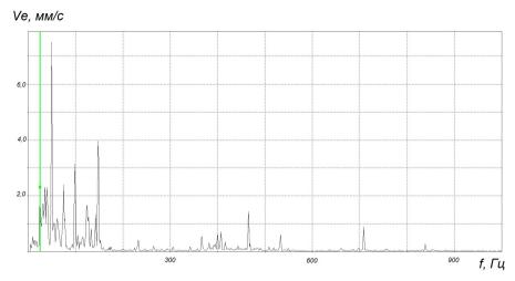
Рисунок 1. Базовый диагностический признак расцентровки валов на примере преобразовательного агрегата ЭКГ-5A
