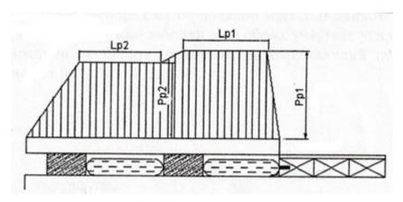
Рисунок 5. Гидрозабойка с двумя запирающими пыжами. Figure 5. Hydraulic tamping with two locking wads.
