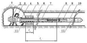
Рисунок 1. Схема гидроимпульсного воздействия на угольный пласт: 1 – горная выработка; 2 – корпус установки; 3 – шланг рабочей жидкости; 4 – труба; 5 – цементный раствор; 6 – угольный пласт; 7 – вязкая жидкость; 8 – разделительный поршень; 9 – ствол установки; 10 – скважина; 11 – шланг вязкой жидкости; 12 – рабочая жидкость
