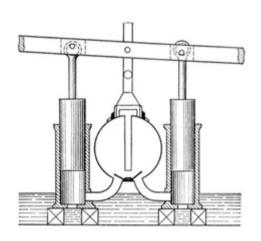
Рисунок 1. Двухцилиндровый поршневой насос Ктесибея Figure 1. Ktesibia Double Cylinder Piston Pump
