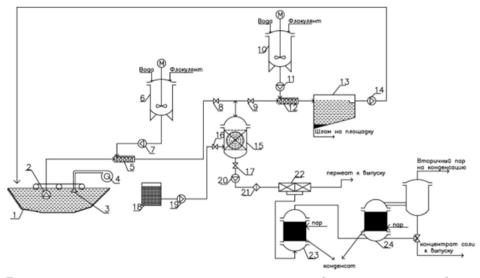
Pucyнок 1. Технологическая схема очистки карьерных сточных вод с использованием обратного осмоса Figure 1. Technological scheme of quarry wastewater treatment using reverse osmosis
