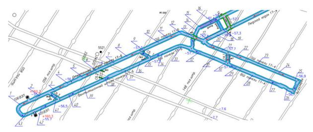
Рисунок 1. Результаты замеров температур горного массива и горной выработки уклонного блока 1Т-4 Figure 1. The rock massif and the mine working of the sloping block 1T-4 temperature measurement results
