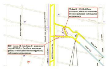
Рисунок 4. Наиболее подверженные прорывам участки НШ-1 (ВПП блока 1Т-4 от сбойки № 1 до кроссинга, сбойка № 1 блока 1Т-4)
