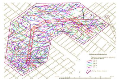
Рисунок 3. Разрывные нарушения участка уклонного блока 1T-4 Figure 3. Dislocations of the inclined block 1T-4 section
